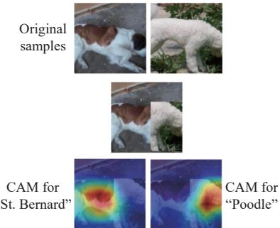
图 5 CutMix 示例及 CAM 可视化结果<sup>[37]</sup>
