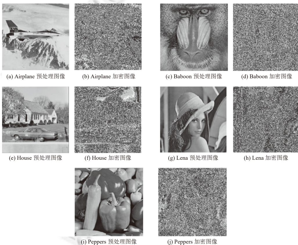
图5 基于 Paillier 同态加密的预处理图像的加密结果
