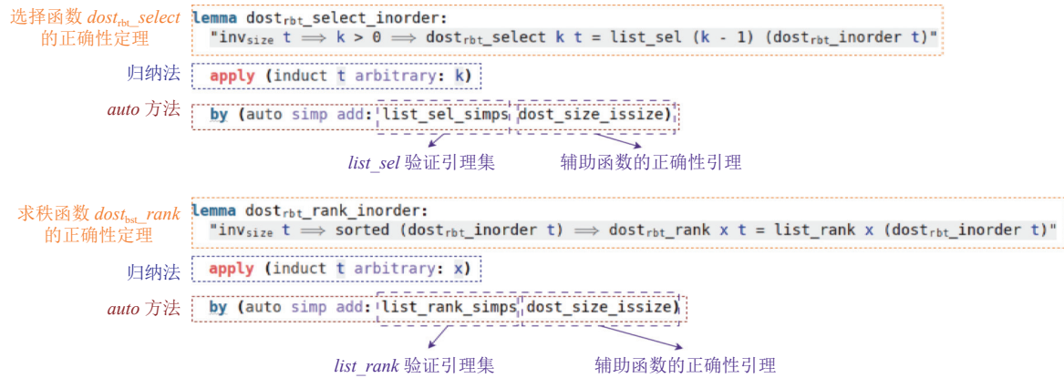
图 20 函数 dost_{rbt\_select} 和 dost_{rbt\_rank} 的功能正确性自动化验证过程
