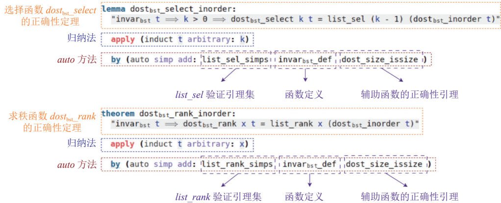
图 18 函数 dost_{bst\_select} 和 dost_{bst\_rank} 的功能正确性自动化验证过程
