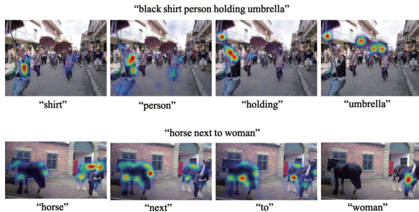
图 5 单个单词对应跨模态对齐模块注意力图 Grad-CAM 可视化结果
