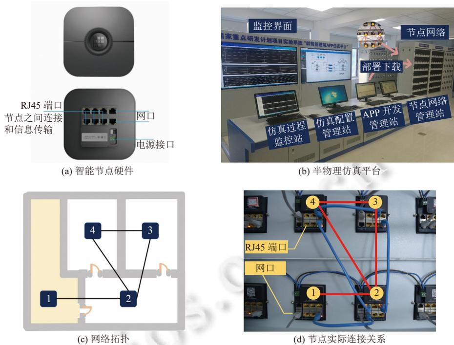
图 12 全分布式智能建筑系统应用程序仿真平台环境搭建
