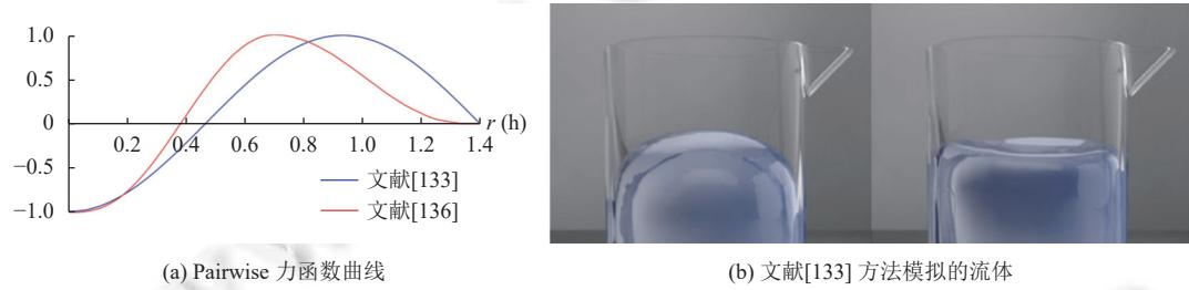
图 9 基于流体内部粒子相互作用力的表面张力
