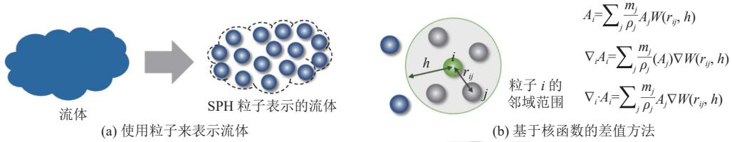
图 2 基于 SPH 核函数的物理场离散化方法
