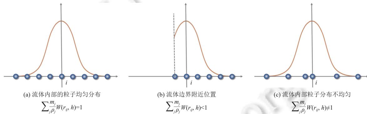
图12 SPH核函数归一化条件及其被破坏的两种情况
