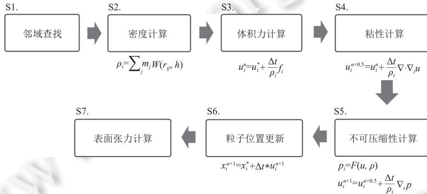
图 3 SPH 法实现流体模拟的基本流程
