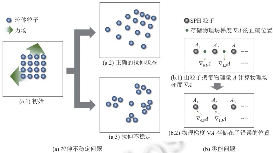
图 11 SPH 的拉伸不稳定问题与零能问题
