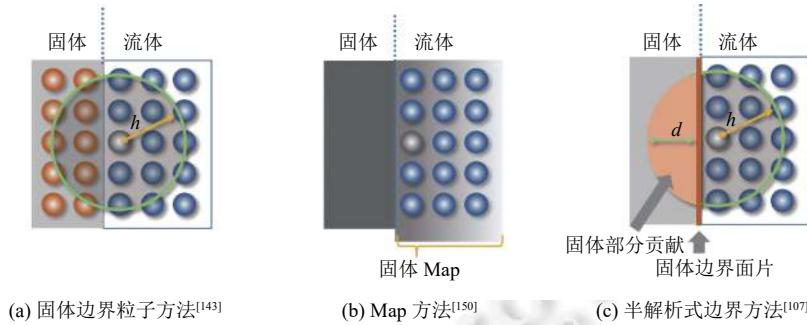
图 13 SPH 法中 3 种固壁边界的对比
