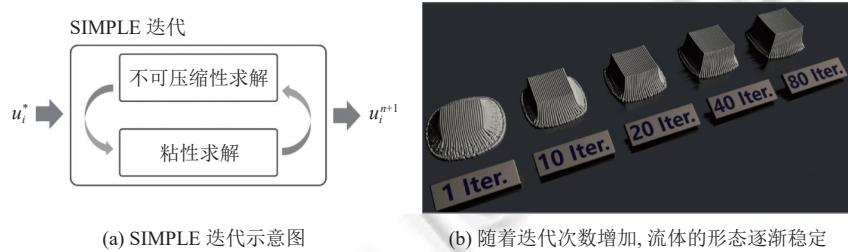
图 15 基于 SPH 的 SIMPLE 迭代算法图示<sup>[79]</sup>
