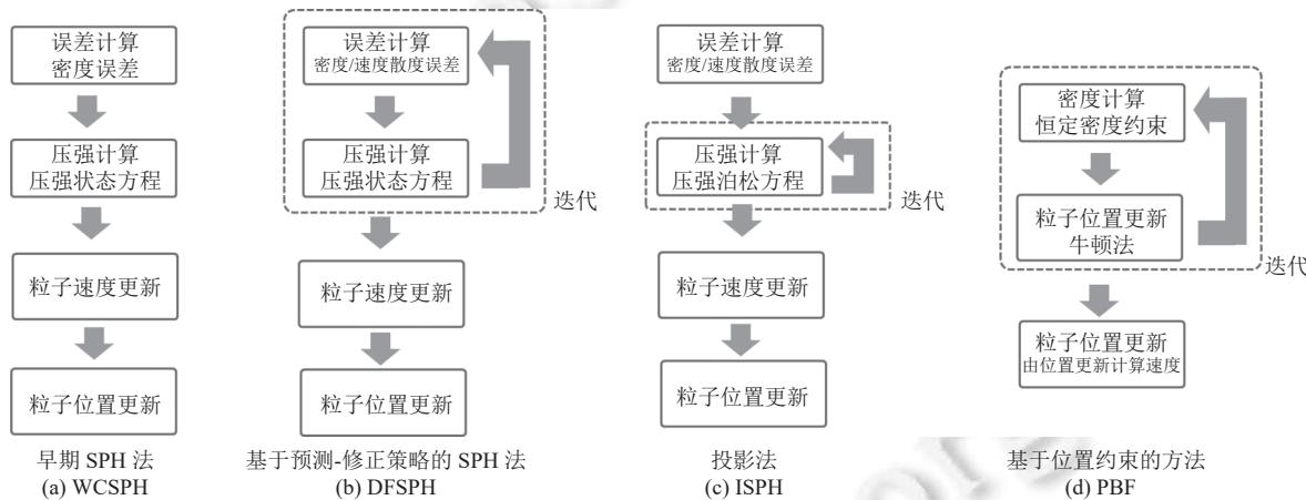
图 5 SPH 不可压缩性求解实现流程对比
