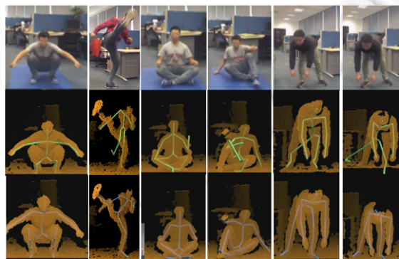
(e) 截取了几帧本文方法(蓝色骨架)与 Kinect(绿色骨架)的姿态重建结果
