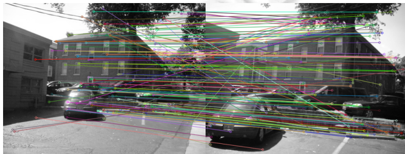
Fig.4 183 matching feature pairs by the improved matching algorithm 图 4 改进的匹配算法匹配 183 对特征点
