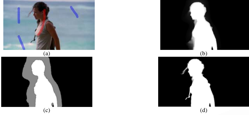
图 4 根据指定的线条以及线条的分布情况所得到的扩散结果,展示了扩散算法的鲁棒性.(a)是和图 5 相同的输入图像.(b)是扩散之后的结果.(c)是由线条扩散所转化而来的三分图.(d)是 \alpha 结果
