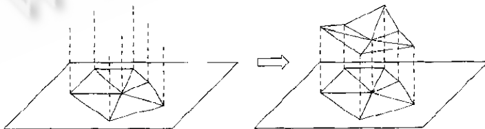
Fig. 1 2D local triangulation and its map to 3D space 图1 二维局部三角化及其到三维空间的映射
