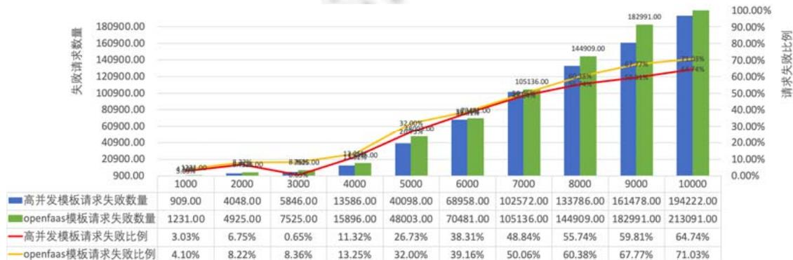
图 13 自动伸缩场景下, 两种函数模板在不同并发数量下的执行情况对比
