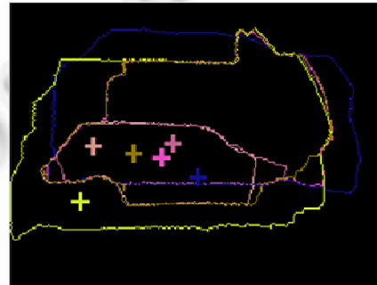
(b) 对不同视点,ASF 得到的粗略轮廓(每个彩色轮廓是经 ASF, 由与其相同颜色的输入视点得到封闭轮廓)
