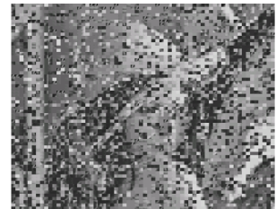
Fig.10 Image compressed by VQ (Channel error PSNR=14.7at 0.625bpp) 图 10 信道有误 VQ 压缩图像 (PSNR=14.7 位率 0.625bpp)
