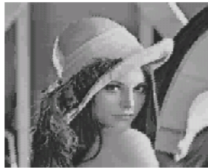
Fig.6 Image compressed by VQ (Noise-free PSNR=27.0 at 0.375bpp) 图 6 无噪声 VQ 压缩图像 (PSNR=27.0 位率 0.375bpp)
