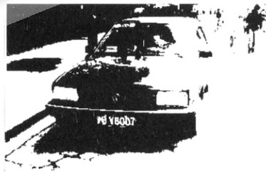
(d) SAS for image segmentation ( TH=89 ) (d) 模拟退火最大似然聚类图像分割 ( TH=89 )
